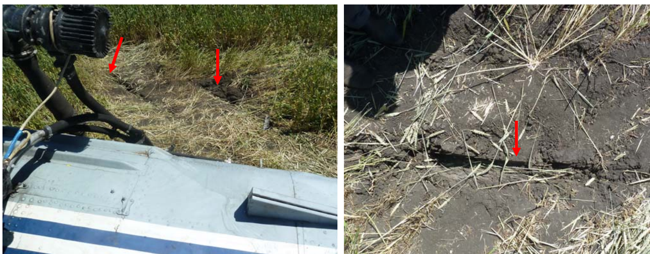
Рис. 2. Следы оставленные разрушенными лопастями при работающих двигателях.
